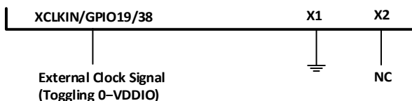
图 3-9 3.3V 外部振荡器的使用
