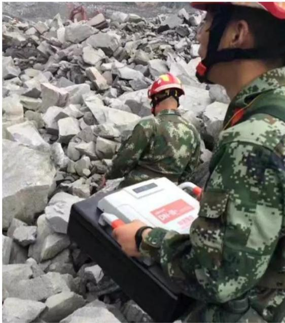
20米左右的废墟, 探测到下面幸存的人员。探测范围较大, 张角达 $120^{\circ}$ 。在众多种类的生命探测仪当中, 雷达生命探测仪是最先进、功能最强大, 且操作简便。
